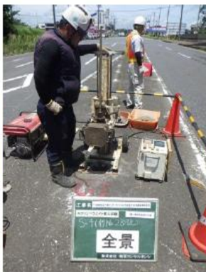
貫入試験による空洞調査
