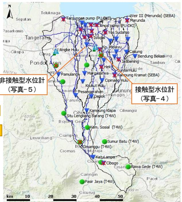
図-5 J-FEWSでの水位計・雨量計配置図<sup>8)</sup>
