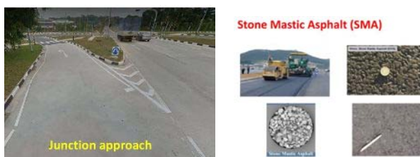
写真-2 各国の主なわだち掘れ対策
